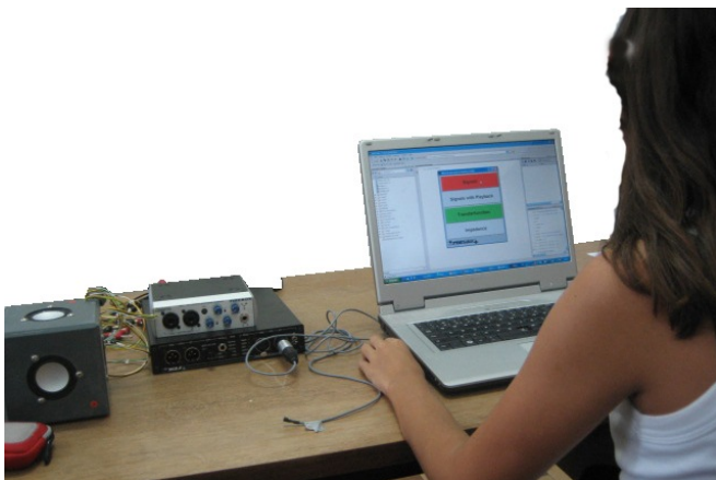
Abbildung 3: Messsystem mit ITA-Toolbox. Mikrofon vereinfachend dicht vor dem Lautsprecher platziert.
